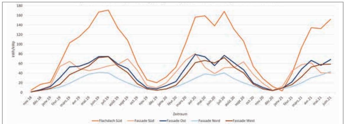
Grafik Oberwiesenstrasse: Gemessener Jahresproduktionsverlauf, umgerechnet in kWh/kWp von Fassaden und Dach
